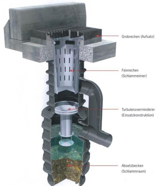
Abb. 23: Separationsstraßenablauf [Grafik: ACO Tiefbau, 2013]
