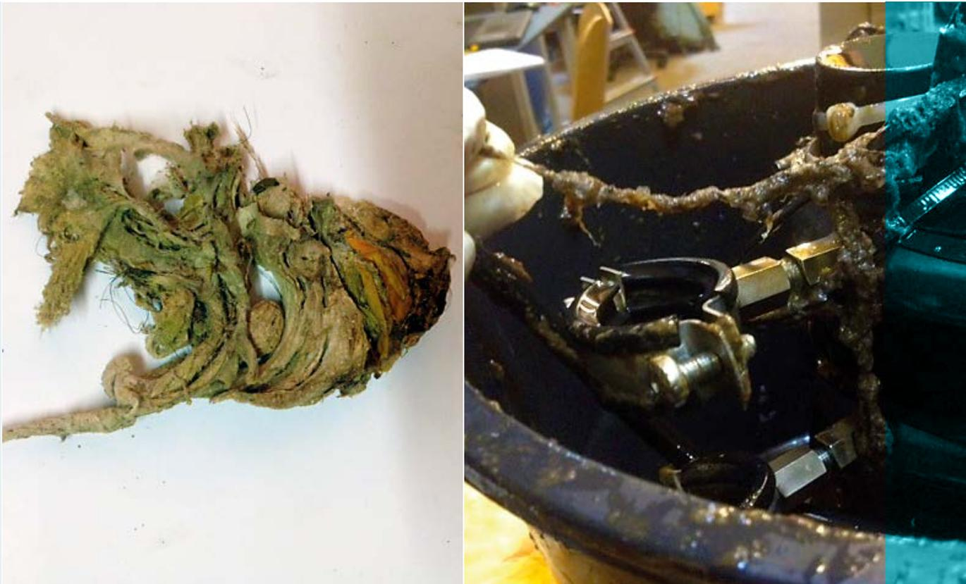
Abb. 4: Pfropfen aus Reinigungstüchern (l.), Verstopfungen im Anlagenzulauf (r.), Quelle: Fraunhofer UMSICHT
