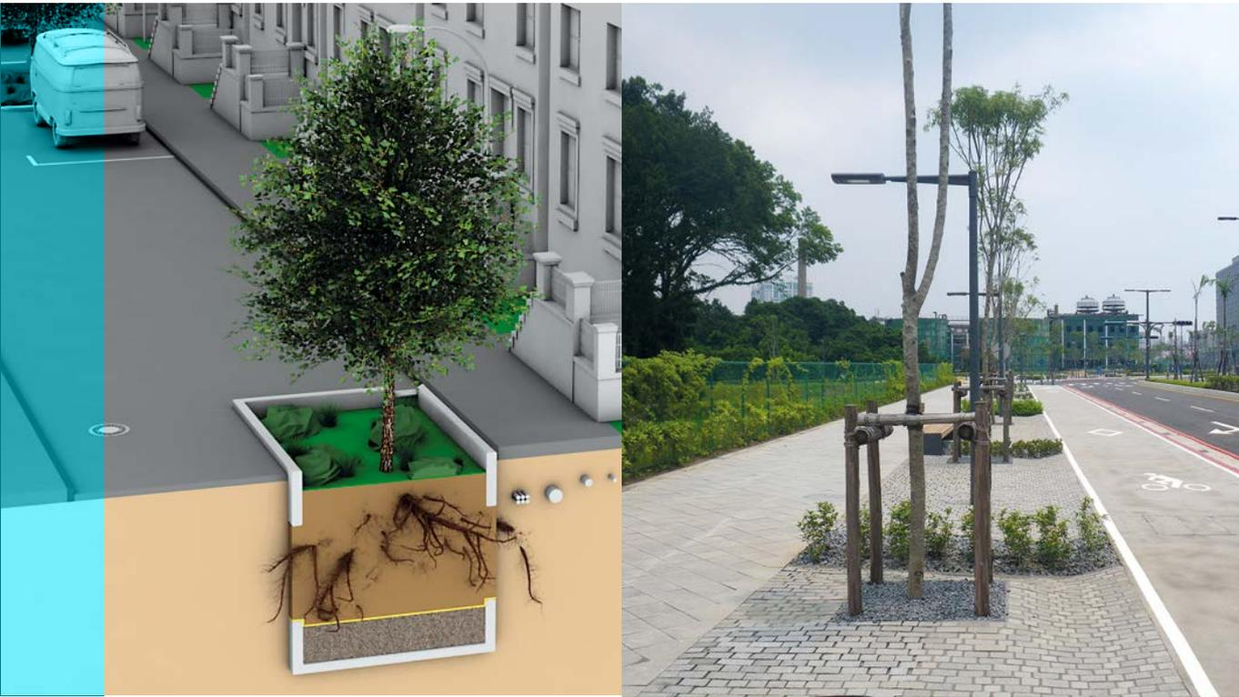
Abb. 3 links: Aufbau Baum-Rigole im Straßenraum. Quelle: Fa. Sieker
