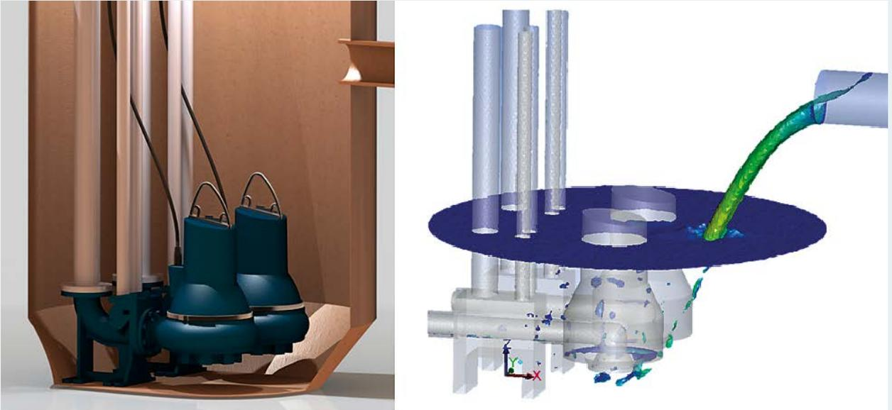
Abb. 3: Abwasserpumpschacht und die numerische Simulation des Lufteintrages in das Abwasser. Quelle: TUB-FSD
