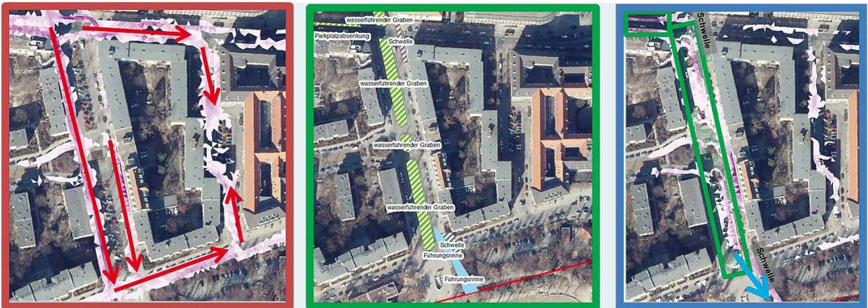
Abb. 2: Simulationsergebnisse zum Starkregenabflussgeschehen auf der Oberfläche
