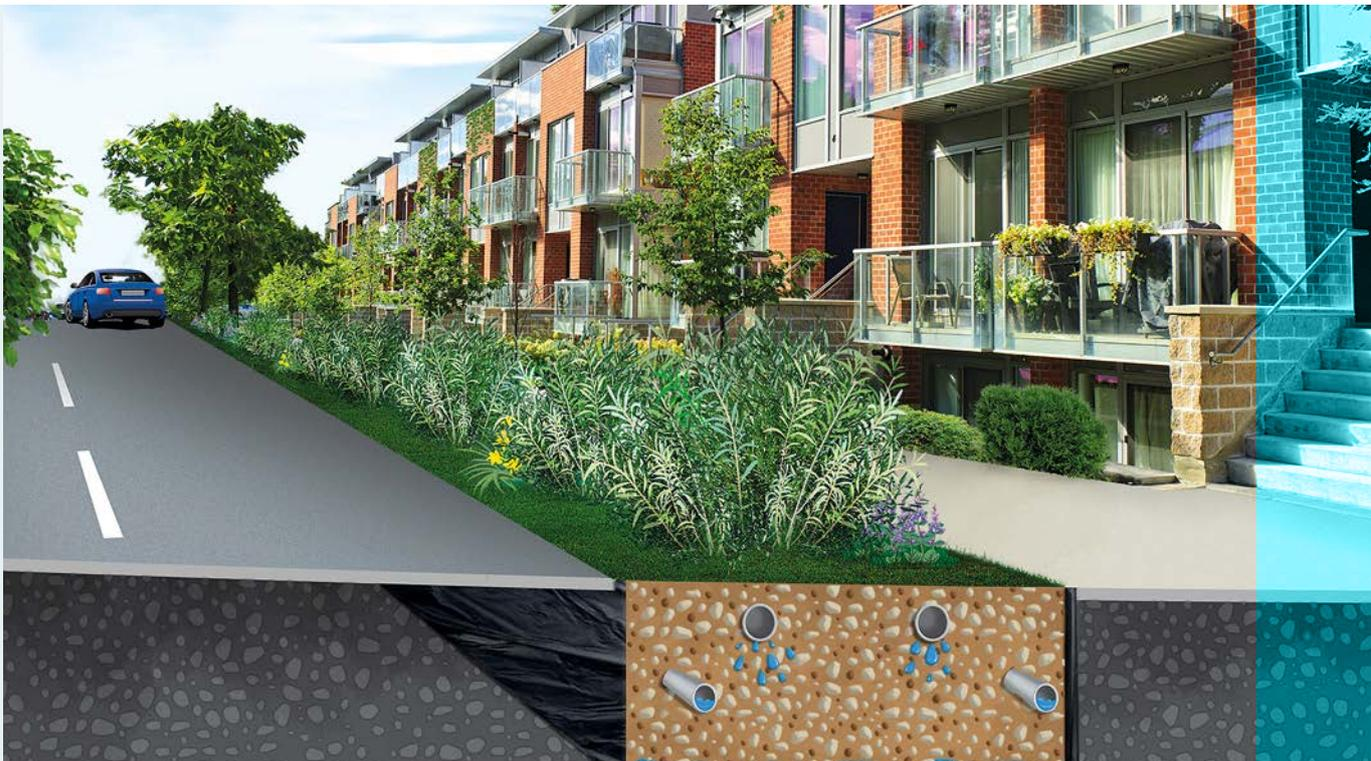
Abb. 1: Energieallee: Mehrfachnutzung der urbanen Fläche zur Wasseraufbereitung, Wasserspeicherung und Bereitstellung von Ökosystemdienstleistungen. Quelle: Fraunhofer ISI
